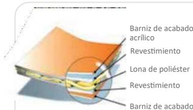
Nuestras cubiertas, en lona de polietileno revestida, ofrecen resistencia mecánica a las tensiones climáticas. Con tratamiento impermeable y anti-UV, tienen una garantía de 10 años\*.
