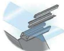
Los perfiles de fijación se utilizan para fijar y tensar la lona.
